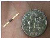
Fig. 3: Tunnel diode, MBD5057-E28.
